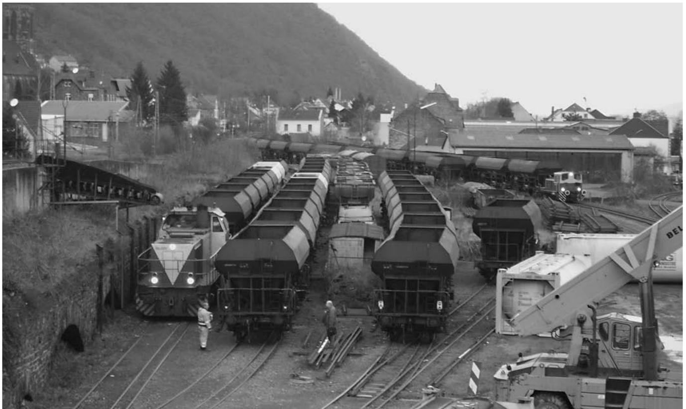
Die kurzen Gleislängen im Umladebahnhof erschweren die Abwicklung der umfangreichen Güterverkehre und erfordern dadurch zusätzlichen Rangieraufwand. Eine Nutzungsmöglichkeit der Gleise 5 bis 7 im DB-Bahnhof Brohl würde eine erhebliche Verbesserung der Situation bedeuten und die Durchführung noch größerer Aufträge durch die Brohltalbahn ermöglichen. (Foto: S. Raab)
