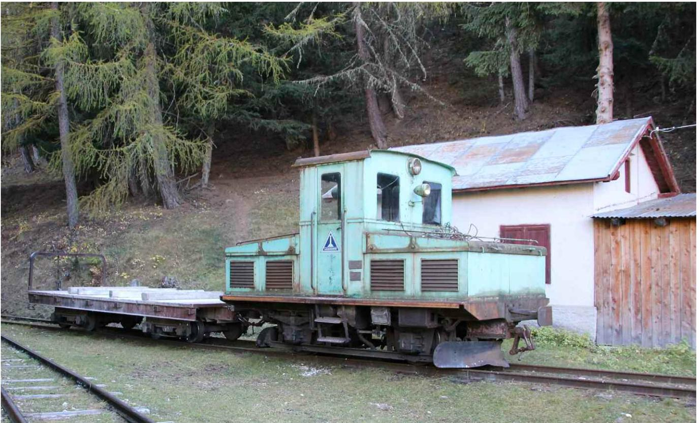
▲ Die zweite Lok in Nahaufnahme im Bereich der Bergstation. Die ehemaligen Akku- bzw. Elektroloks fahren seit 1997 mit Diesel.
