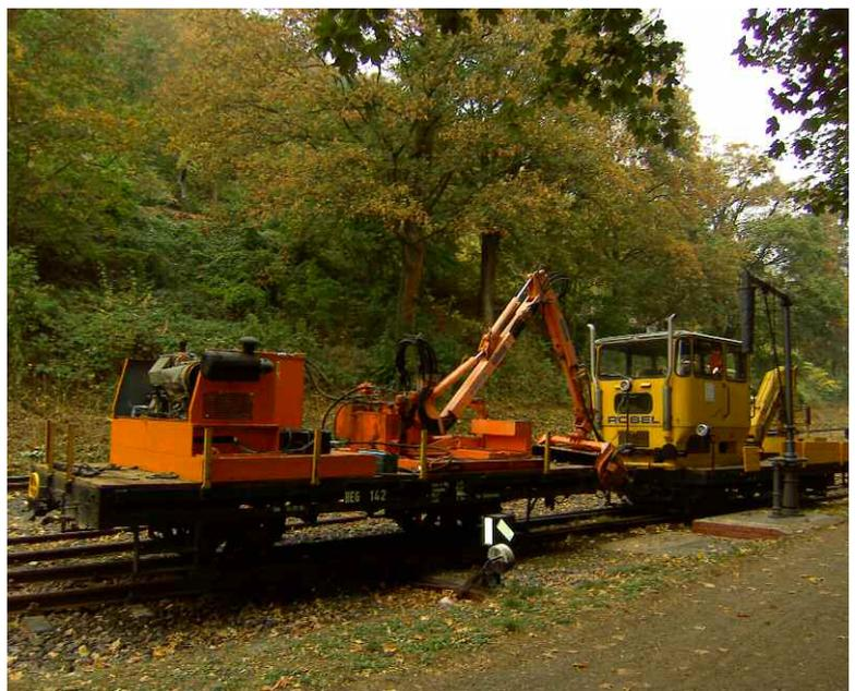
▲ Auf dem Fahrzeug montiert, kann der Mulcher sowohl mit unseren Dieselloks als auch mit dem Skl eingesetzt werden.
