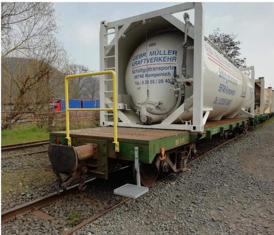
▲ Alle im Phonolith-Verkehr eingesetzten Containertragwagen sind nun mit Geländern und beidseitigen Rangierertritten ausgestattet worden.
