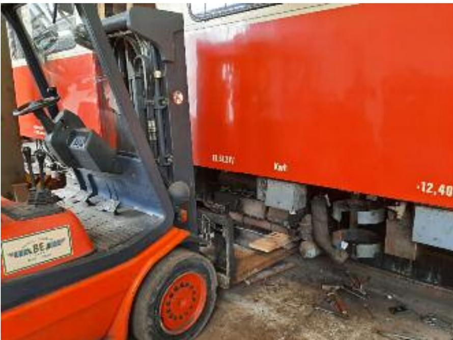
◀ Der Ausbau der Motoren geschah unter Zuhilfenahme des Gabelstaplers.
