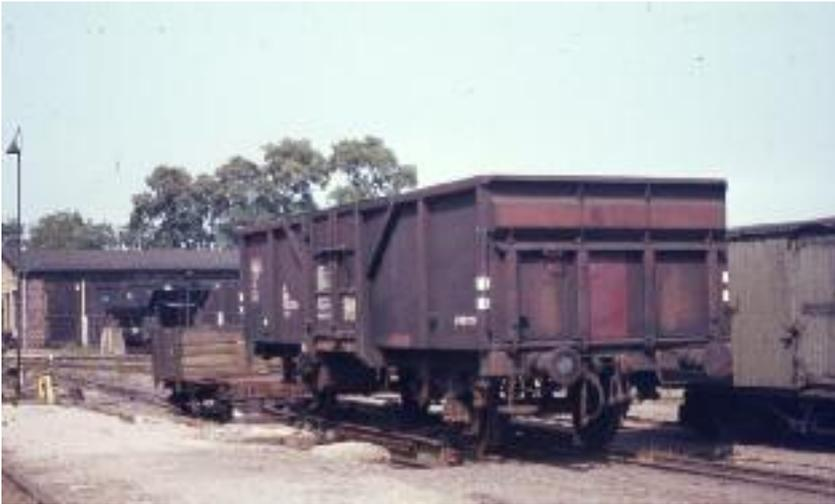
◀▼ Auch die Rollwagengrube war 1973 noch in Betrieb. Besonderheit der Brohler Anlage war, dass sie auch von der Normalspurseite her mittels Dreischienengleis auf Meterspur erreichbar war.
