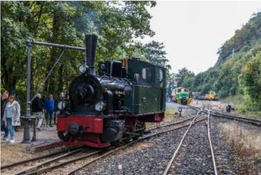
▲ Neben dem Nachladen von Kohle im Bereich der alten Wagenwerkstatt, war für die Dampfloks auch das Wasserfassen elementar. Lok „Hoya“ ist hier am 10. Oktober 2021 am Brohler Wasserkran zu sehen, während im Hintergrund D 2 mit dem kurzen Zug in den Hafen bereit steht.
