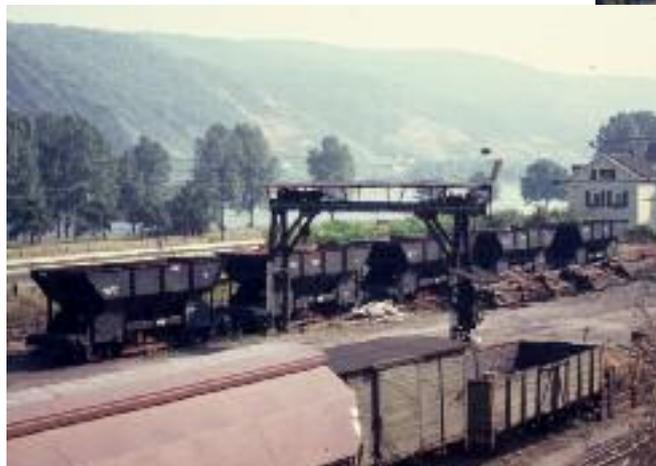
der Hafengleise nützlich war. Im Umladebahnhof stehen denn auch etliche Regelspur-Schüttgutwagen, darunter auch ein Klappdeckelwagen. Weitere Besonderheiten sind die bis 1978 genutzte Rollwagengrube, der Portalkran und die Überspannung der Dreischienengleise mit der Oberleitung der DB.
