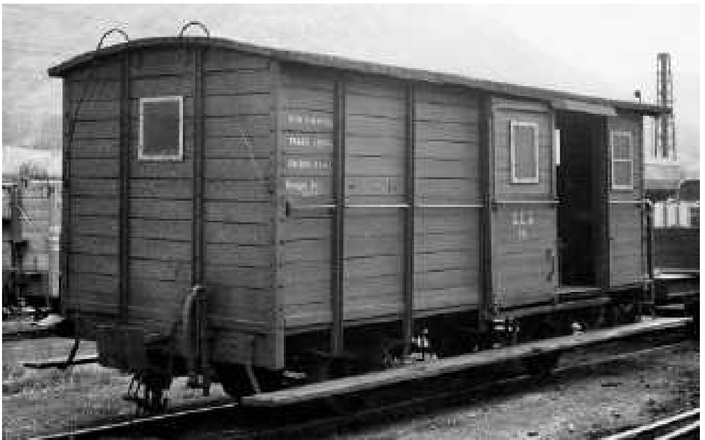
Wagen Pw/Post2 71 , ( bis 1929: Nr. 7 ); van der Zypen & Charlier 1901; Tragfähigkeit: 7,5 t; ( Foto: im Umladebahnhof Brohl 27.07.1962: F.K.von der Berswordt )
