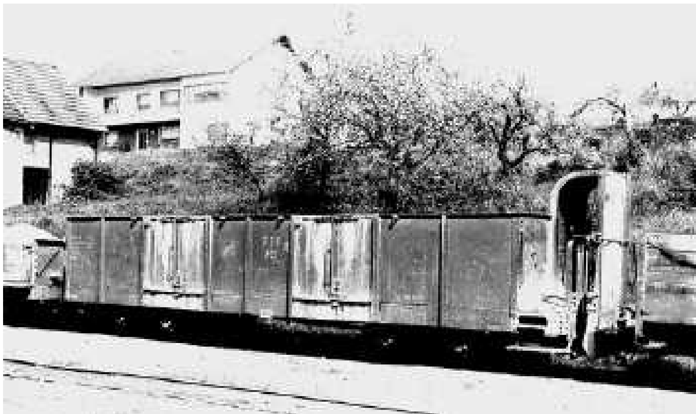
Wagen 00m4 421 ; van der Zypen & Chavlier 1927; Tragfähigkeit 20 t; es Euskirchener Kreisbahn 1967 an BEG (Foto: im Bf. Oberzissen 15.05.1970: G. Wolff)
