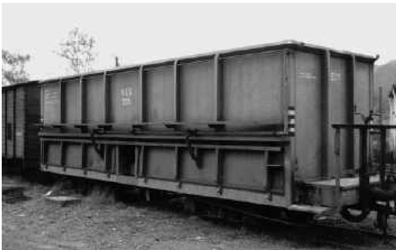
Wagen 00t4 532 ; Schwefer 1961; Tragfähigkeit: 30 t; 1984 nach Malaysia verkauft; ( Foto: im Umladebahnhof Brohl 04.04.1979: H.W.Ostermann, Dortmund )
