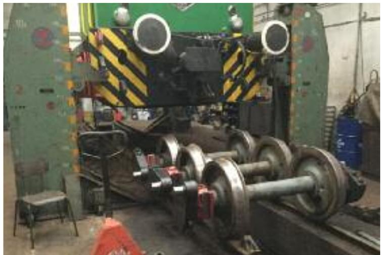
▲ Die Radsatzgruppe der D1 nach dem Heben der Lokomotive. Man erkennt leicht die geringe Reststärke der Radreifen.
