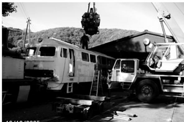
**Motorausbau an der Diesellok D 5** am 18. Oktober 2005. Zum Einbau der speziell angefertigten Motorenlager war der Ausbau des Motors notwendig geworden.
