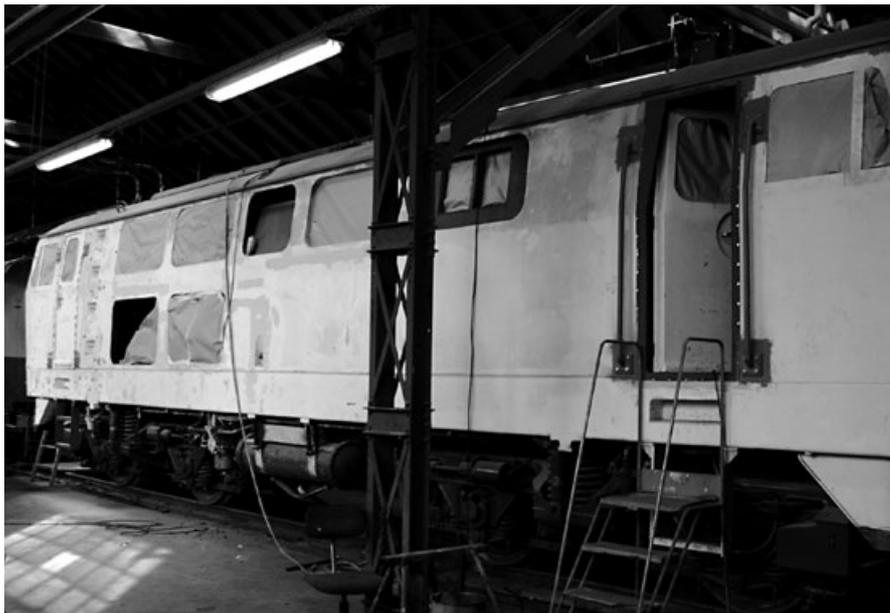
Vor der Gesamtlackierung wird diese Seite der Lok gespachtelt und mit Rostschutz versehen. Die Hauptarbeit ist damit getan, doch sind an Lok D 5 noch einige Stunden zu leisten, bis die neue Attraktion der Brohltalbahn für den Zugdienst eingesetzt werden kann. (Foto: Ortwin Wildeman)
