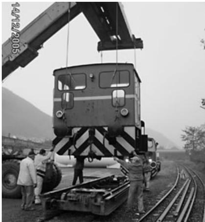
Abladen und Aufsetzen der Lok auf einen Rollwagen mit Normalspur im Umladebahnhof Brohl am 14.12.05 (Foto: Stefan Raab)
