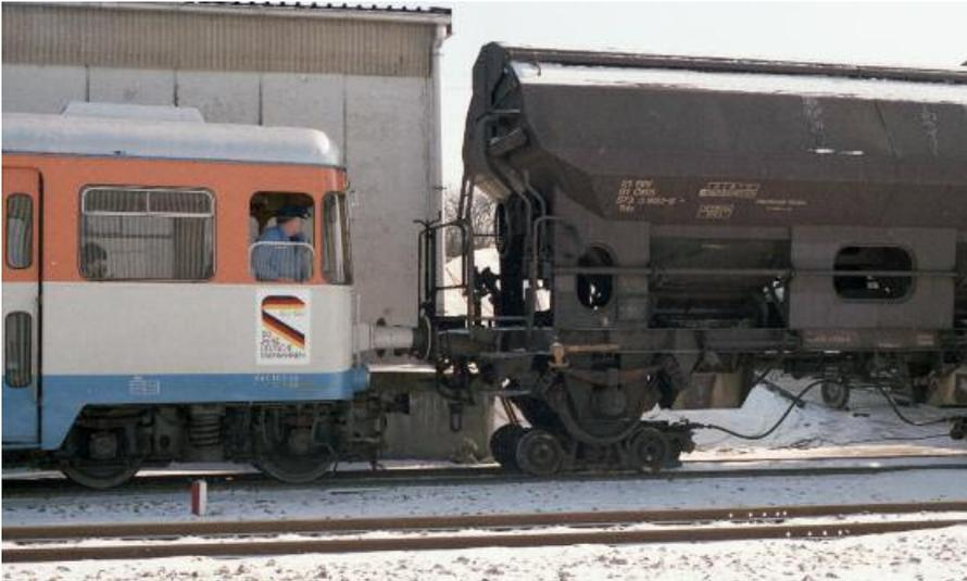
▲ Triebwagen VT 30 am 11. Februar 1985 im Bahnhof Nellingen zusammen mit einem auf Rollböcke aufgeschemelten Normalspurwagen. Hier zeigt sich die große Vielseitigkeit des Fahrzeugs. Die Motorleistung von 680 PS der 4 Büssing U 11 D Motoren gepaart mit der effizienten hydromechanischen Kraftübertragung der Voith Differentialwandlergetriebe ermöglicht das Befördern hoher Anhängelasten auch auf steigungsreichen Strecken.
