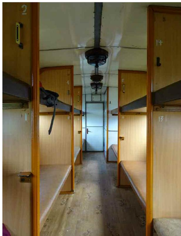
▲ Blick in unseren Liegewagen älteren Datums: 16 Liegeplätze sind in Fahrtrichtung angelegt, jeweils mit oberer und unterer Liege. In den Neubau-Wagen sind die oberen Liegen hochklappbar, aus den unteren entstehen durch Umklappen Sitze und ein Tisch.
