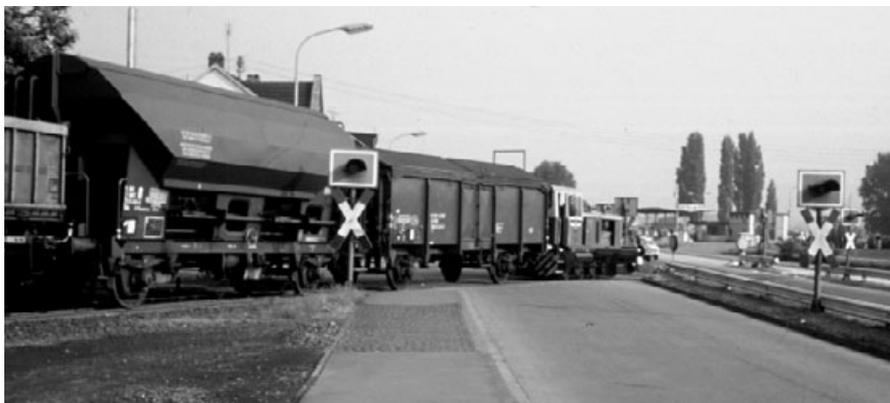
Ein Güterzug vom Umladebahnhof Brohl mit Normalspurwagen und Lok D 2 überquert am 25.06.1974 auf dem Dreischienengleis die B 9. Die Lichtzeichenanlage für den Bahnübergang ist bereits vorhanden. Im Vergleich zu den heute üblichen Ganzzügen deutet die Kombination aus einem Wagen mit Hubschiebedach (Kmmks), einem offenen Seitenentladewagen (Otm, heute Fc) und einem Behältertragwagen (BTmms) auf die Be- bzw. Entladung unterschiedlicher Güter im Hafen hin.
