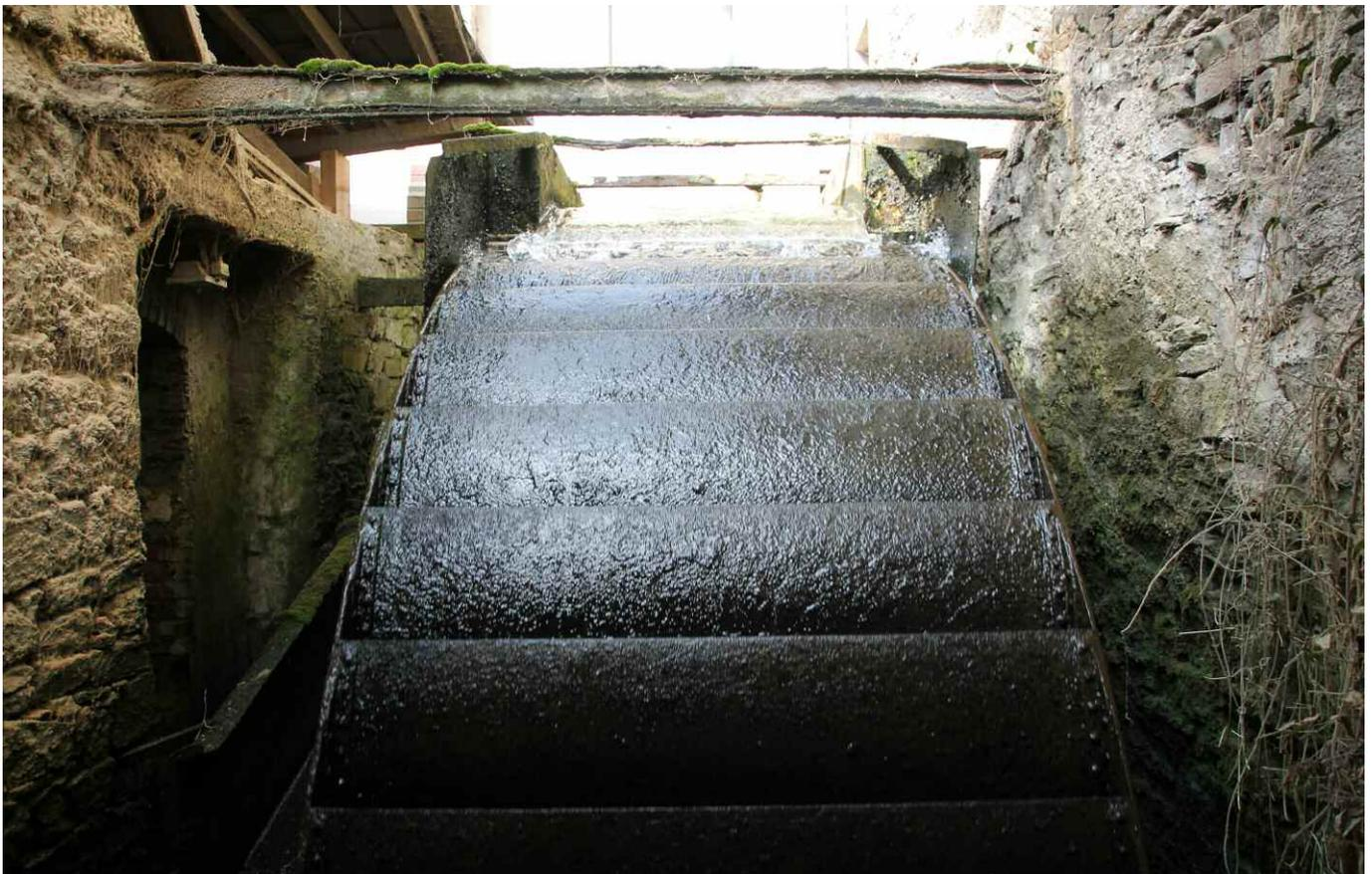
▲ Der Brohltbach treibt das oberflächliche Wasserrad an, das seine Kraft wiederum über Transmissionsriemen auf das Mahlwerk überträgt.
