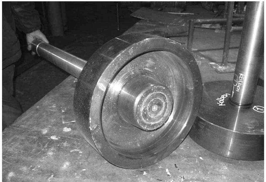
Bild 1 Kolbenrohlinge
