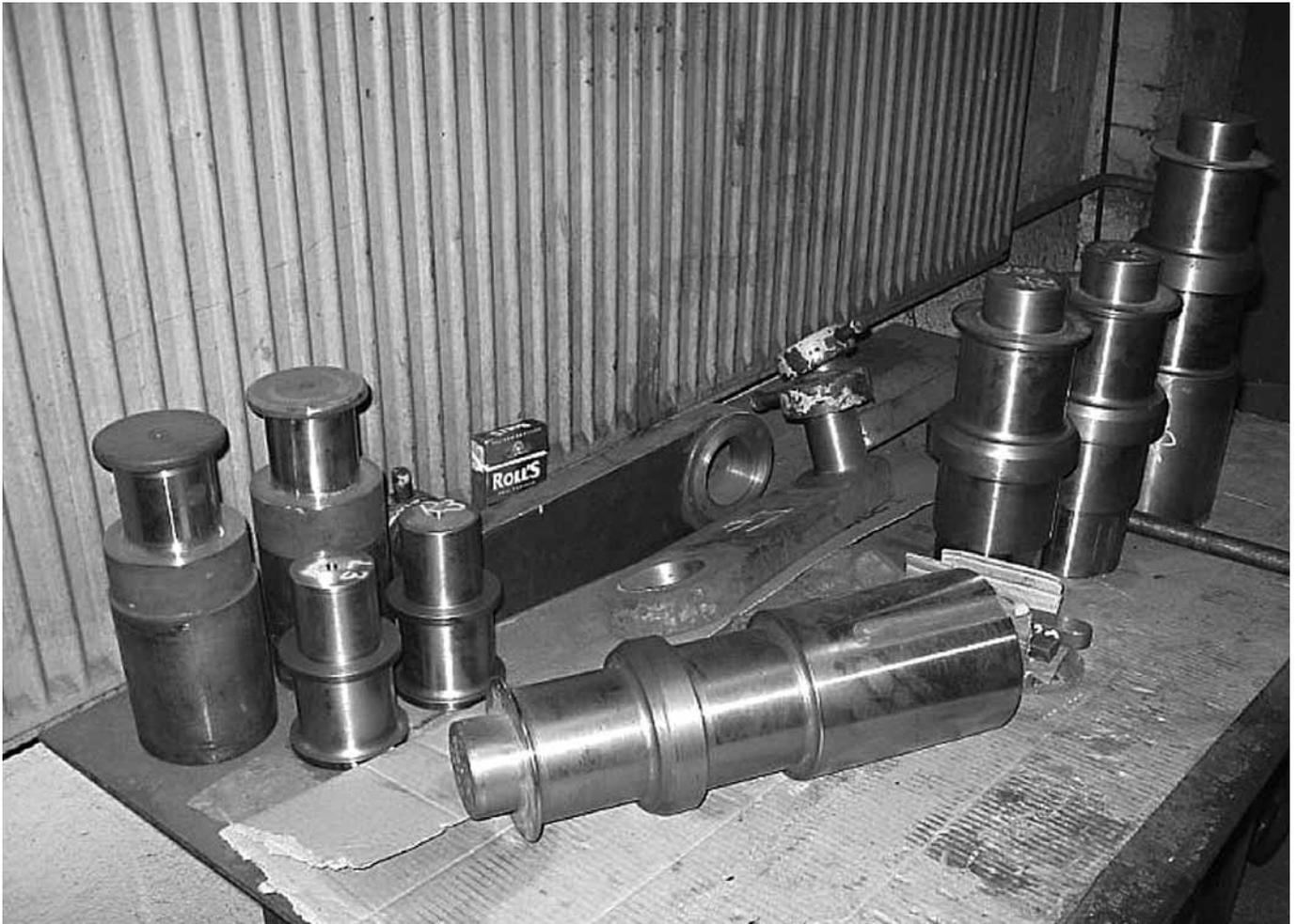
Bild 5 Neue Kuppel- und Treibzapfen sowie aufgearbeitete Schwingenkurbeln
