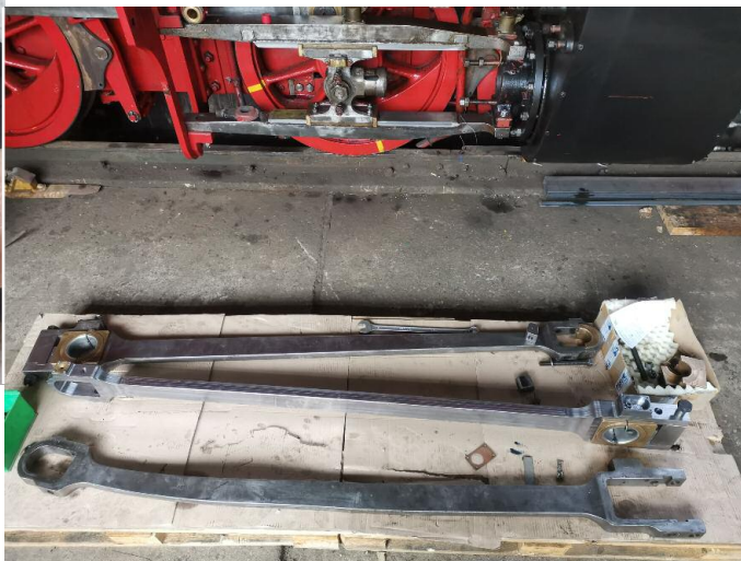
◀ Passprobe des neuen Schmiergefäßdeckels der Treibstange. Der neue Schmiergefäßdeckel passt! Foto: Rafael Wunderwald
