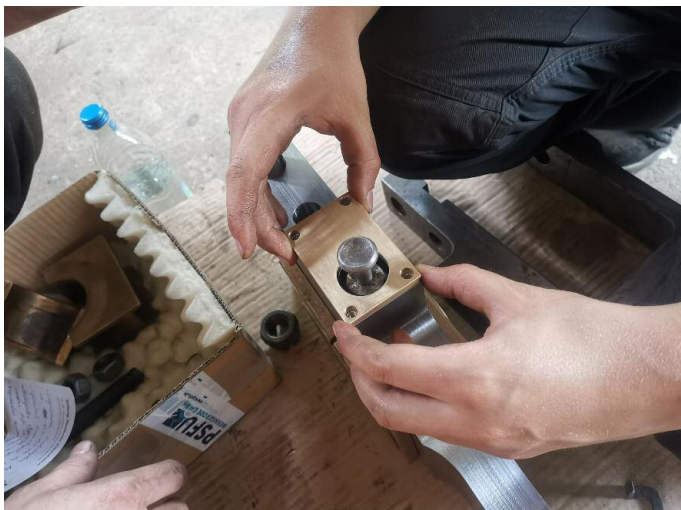
◀ Passprobe des neuen Schmiergefäßdeckels der Treibstange. Der neue Schmiergefäßdeckel passt! Foto: Rafael Wunderwald
