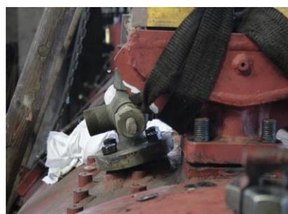
Bei der probeweisen Montage des Dampfheizventils wurde eine Reihe von Mängeln und Problemen am neu gebauten Sicherheitsventilstutzen festgestellt, da das Ventil im Bereich der Überwurfmutter der Spindel mit dem Sicherheitsventilstutzen kollidiert. Weiterhin wurden beim Prüfen weitere Mängel erkannt, die einen nochmaligen Neubau des Sicherheitsventilstutzens erfordern.
