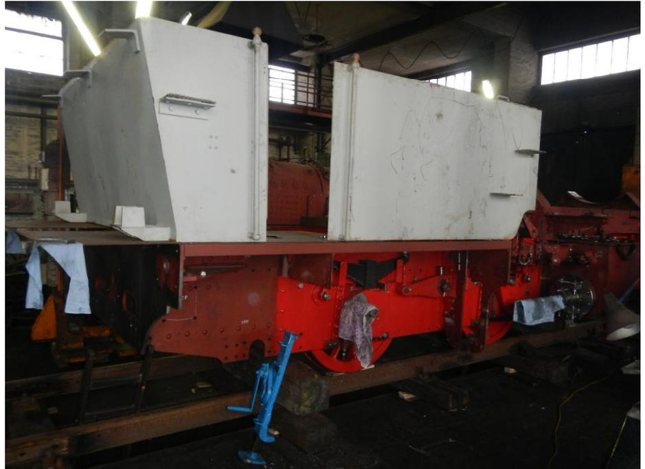
Die von MaLoWa neu gefertigten Führerhausteile wurden probeweise zur Übersicht Mitte Januar auf den Rahmen gesetzt.
