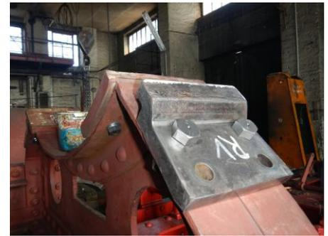
Die vordere Auflage für den Kessel mit der neu gebauten Befestigungsaufnahme
