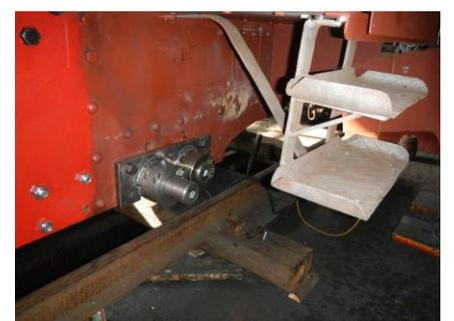
Die eingebauten hinteren Bremswellen noch ohne Bremszylinderhebel. Auf dem rechten Bild ist auch der alte angebaute linke Tritt ersichtlich.
