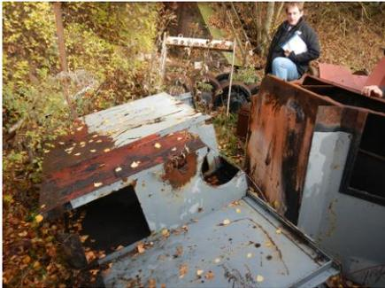
Die bereits im Vorfeld in Eigeninitiative der Firma MaLoWa bei einem Stahlbauer nach dem Original gefertigten Rückwand- und Seitenteile beinhalteten aufgrund des 1:1 Nachbaues „Alt-Reparaturfehler“ und zusätzliche geometrische Abweichungen.
