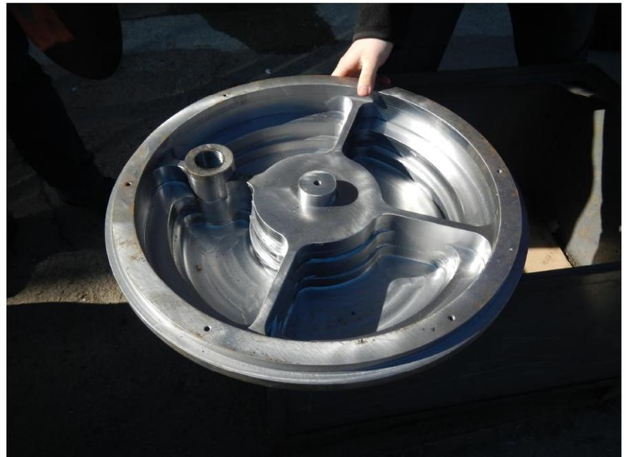
Vor der Montage zeigte sich ein durchgehender Riss im alten vorderen linken Zylinderdeckel, deshalb musste zusätzlich ein neuer Zylinderdeckel in Rheinbrohl hergestellt werden.
