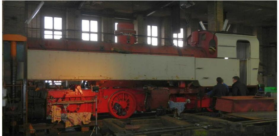
Der aufgesetzte linke alte Wasserkasten lässt die entstanden Schäden im Laufe des Loklebens deutlich erkennen.
