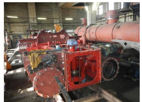
Angebaut auf der Rückseite der Lok sind die Zug- und Stoßvorrichtungen für beide Spurweiten, während auf der vorderen Seite noch die gesamte Pufferbohle fehlt.
