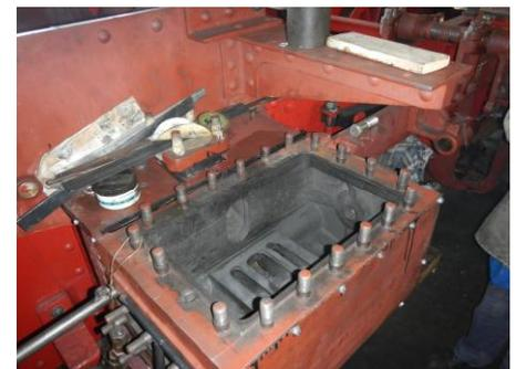
Die Schleifarbeiten am Schieberspiegel HL wurden nicht mehr fortgeführt. Hier wird nur noch eine mechanische Bearbeitung auf einer Fräsmaschine übrigbleiben, dies bedingt jedoch einen Abbau des Zylinders. Eine andere Lösung wird noch gesucht.
