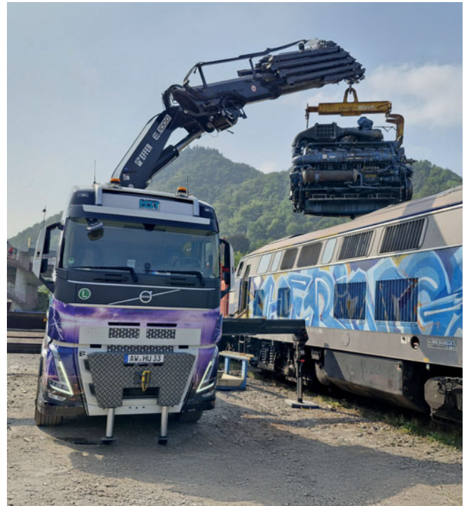
▲ Aus der bei der Fa. Hering eingesetzten 218 450-5 ist im August der schadhafte Motor ausgebaut worden. Die Lok wird zeitnah mit einem Austauschmotor versehen. Foto: Andreas Thiel
