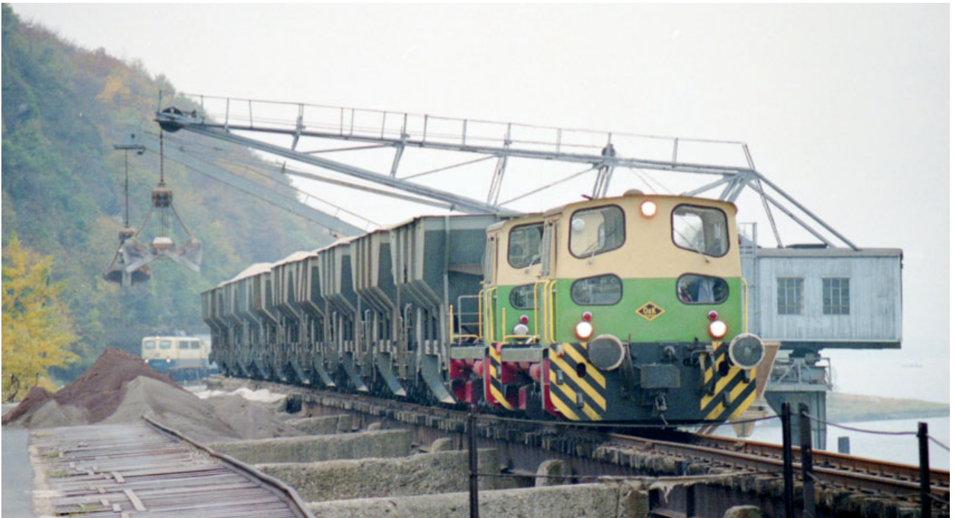
▲ Die Entladung des Phonolithzuges auf der Sturzbunkerbrücke ist auf diesem Foto 31. Oktober 1988 erkennbar. Bis 1994 wurden die Züge auf diese Weise über dem Trockenbunker entladen. Das Material gelangte von dort per Kran Schaufel für Schaufel auf Bahn und Schiff.
