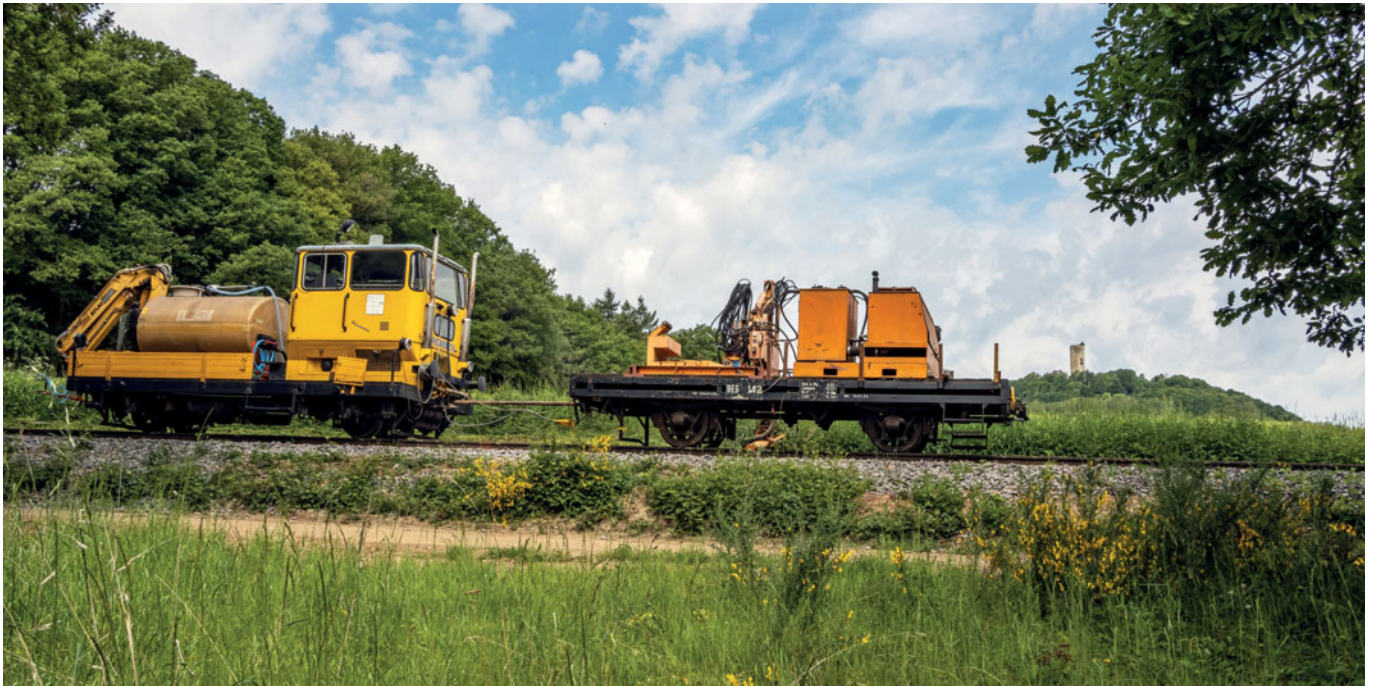
▲ Mittels Skl wird die Vegetationspflege stark vereinfacht. Auf dem Beiwagen 142 ist der Mähbalken / Mulcher montiert, während der Skl selbst nun eine Anlage zur chemischen Aufwuchsbekämpfung trägt. Foto: Rüdiger Balhar
