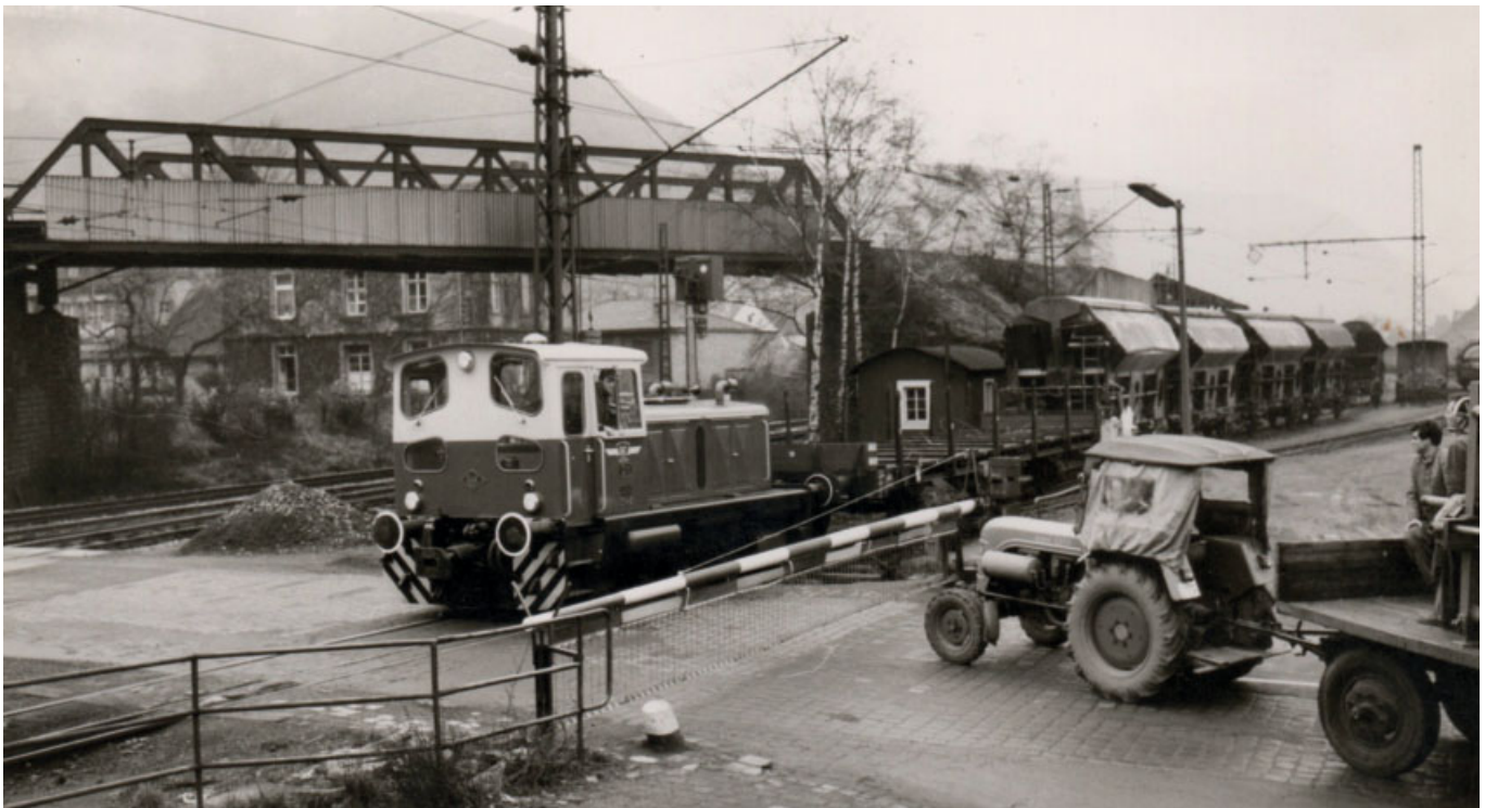
▲ Die asymmetrisch versetzt angebrachten Normalspurpuffer der Dieselloks D1 bis D3 ermöglichen es, auch Normalspurwagen auf dem Dreischienengleis des Umladebahnhofes sowie auf der Hafenbahn zu befördern. Diese Aufnahme zeigt die D1 im Jahr 1965 beim Rangieren auf dem früheren Bahnübergang der B412 in Brohl. Foto: IBS-Archiv
