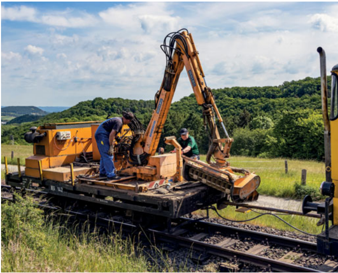
▲ Nach Abschluss der Mäharbeiten muss der Mulcher wieder sicher auf dem Beiwagen verstaut werden. Foto: Rüdiger Balhar
