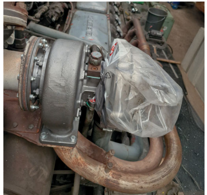
▲ Der aufgearbeitete Turbolader der D1 konnte inzwischen wieder eingebaut werden.
