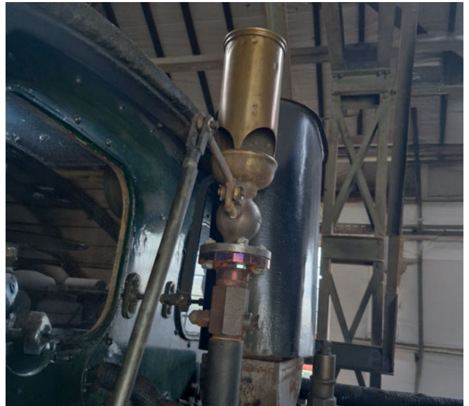
▲ An Lok 11 sm wurde die bisherige, sehr hell klingende Pfeife durch die zuletzt an Lok V (Px48) montierte Pfeife ersetzt. Seither klingen wieder die dunkleren, ein wenig an den „Wilden Westen“ erinnernden Klänge durch das Brohltal.
