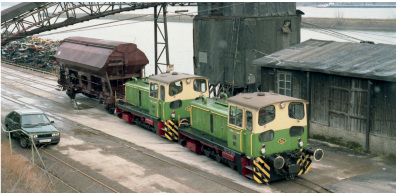
▲ Im Hafen wurde die steinerne Fracht entladen. Die Züge fuhren dazu mit den Loks voran bis in das Gefälle zum Kai. Dort wurden die Loks abgekuppelt, in das Stumpfgleis 2 (hier ganz links im Bild) gefahren und die Waggons anschließend mittels Schwerkraft in die Gleise 3 und 4 (die beiden rechten Gleise) rollen gelassen. Nach dem Wiederankuppeln der Loks wurden die Wagen die Steigung wieder hinaufgezogen und anschließend auf das Sturzbunkergleis gedrückt, um dort über den Bunkern entladen zu werden. So wurde vermieden, die Züge bereits ab dem Umladebahnhof in den Hafen schieben zu müssen. Die Loks D2 und D3 sind hier am 08. März 1988 bei der Abholung eines normalspurigen Schüttgutwagens zu sehen.
