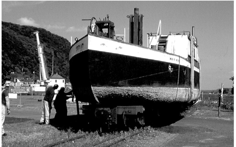
Nach der Fahrt auf dem Hafengleis bis zum Aufstellungsort nördlich der Tankstelle werden die Vorbereitungen zum Abheben des Kutters mit Hilfe des Krans getroffen
